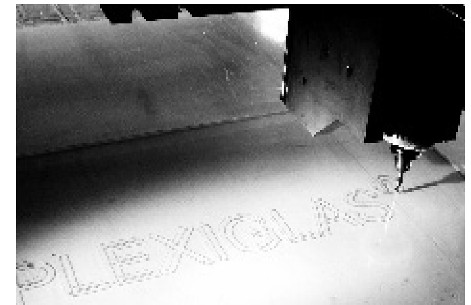
Abb. 27: Gravieren mit einer CNC-gesteuerten Portalfräsmaschine; einschneidiger Gravierstichel
