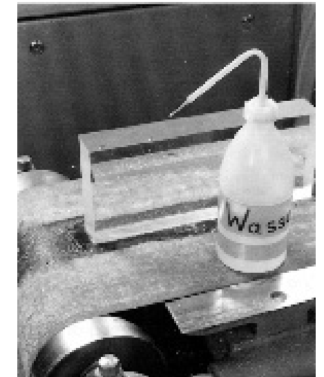
Abb. 38: Nassschleifen auf einer Bandschleifmaschine
