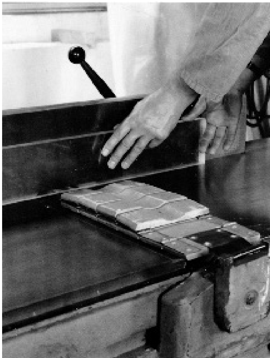
Abb. 36: Glätten der Kanten mit Abrichthobel
