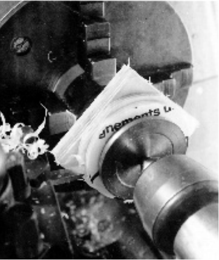
Abb. 30: Scheiben-Runddrehen zwischen Spannfutter und Reitstock
