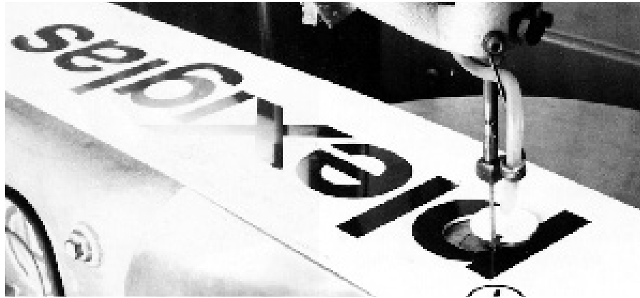
Abb. 9: Schwingsäge schneidet Schriftzug PLEXIGLAS®
